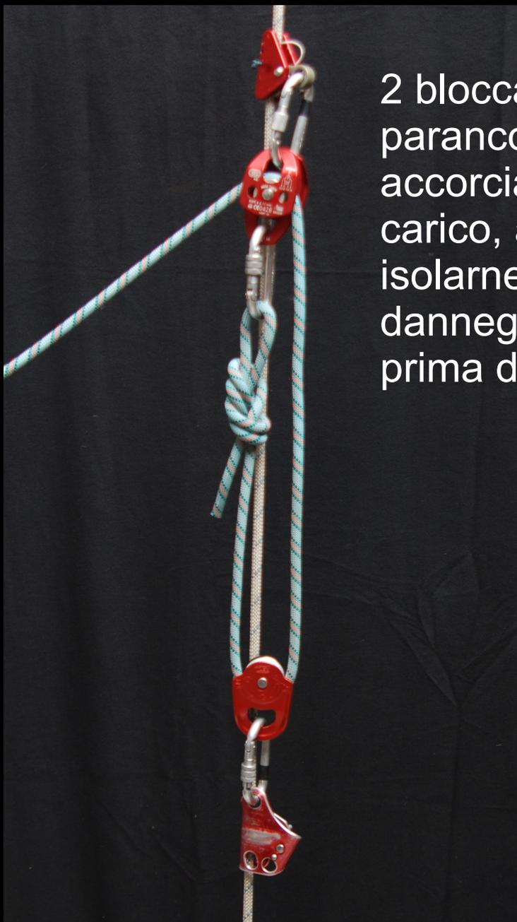
2 bloccanti contrapposti e un paranco permettono di accorciare una corda sotto carico, ad esempio per isolarne una parte danneggiata con un nodo prima di rimuovere il sistema.
