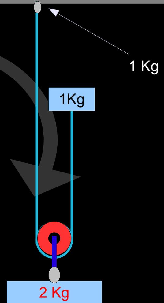
Ribaltando l'immagine i valori delle forze non cambiano. Il disegno a destra permette di visualizzare il vantaggio meccanico che fornisce il sistema.
