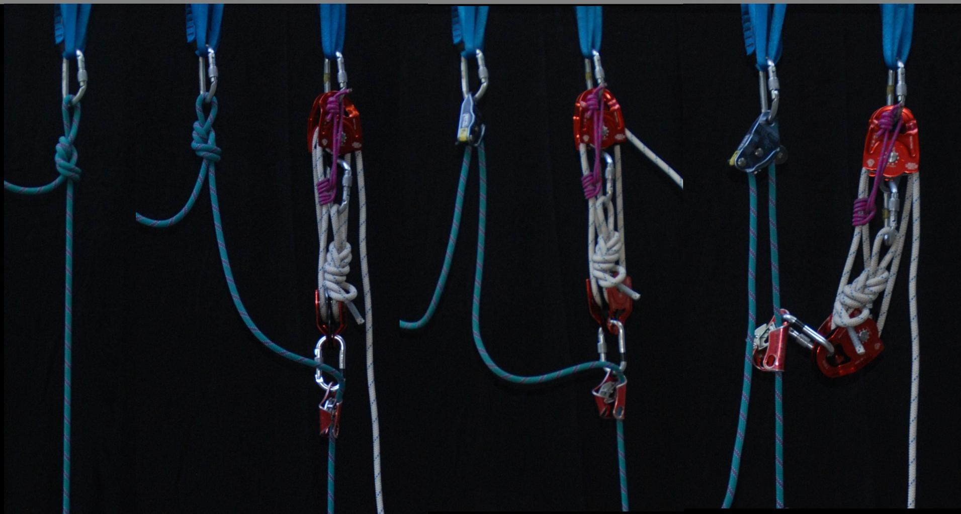
In questo caso il paranco è servito a sostituire l'ancoraggio iniziale con un discensore autobloccante, che permette il recupero ciclico della corda con il suo carico e/o l'eventuale calata.
