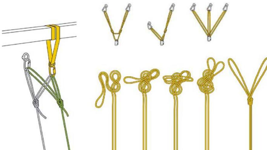
“**Ancoraggio statico**” quello in cui si mantiene la corda sottoposta al carico in una direzione predeterminata, è necessario che la lunghezza dei bracci sia regolata al fine di ripartire il carico sui vari punti di attacco.
